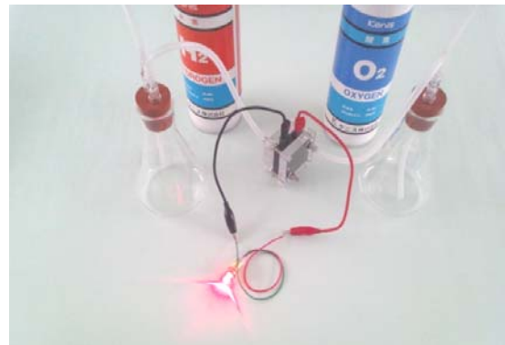
実験例：水素ガスと酸素ガスで発電しLED電球を点灯！
